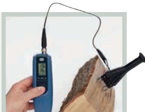
**ANWENDUNG** Feuchtemessung mit einer **M 20-Elektrode** quer zur Faserrichtung des Holzes
