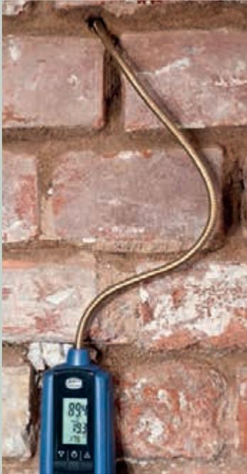
**ANWENDUNG** Mit dem flexiblen Fühlerrohr sind Messungen an schwer zugänglichen Stellen einfach und bequem durchzuführen.
