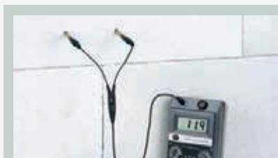
**ANWENDUNG** Messung mit einem Tiefen-Messelektrodenpaar M 21-250
